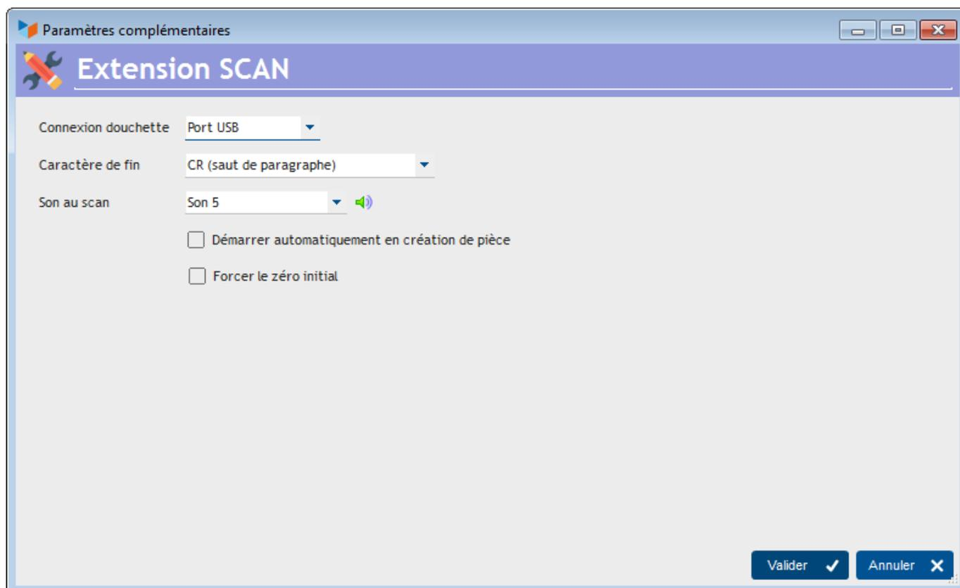
La combo **Connexion douchette** permet de préciser le mode de connexion. Actuellement, seul le port USB est pris en charge. Certaines douchettes se connectaient sur un port RD232, mais ce sont des modèles collector !
